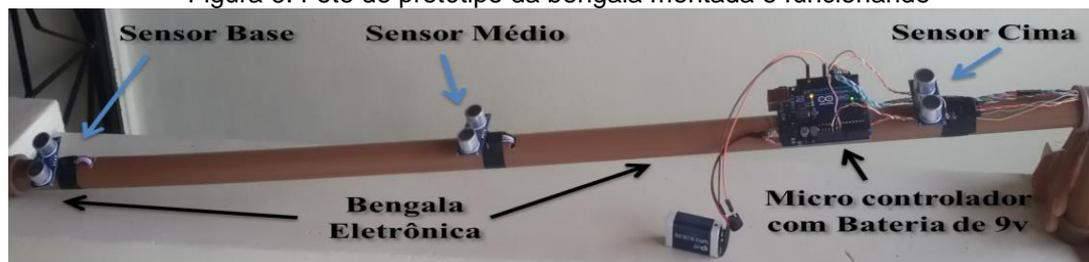
Uma segunda adequação para inserção dos sensores ultrassônicos foi a de inseri-los na tubulação (Figura 7).
