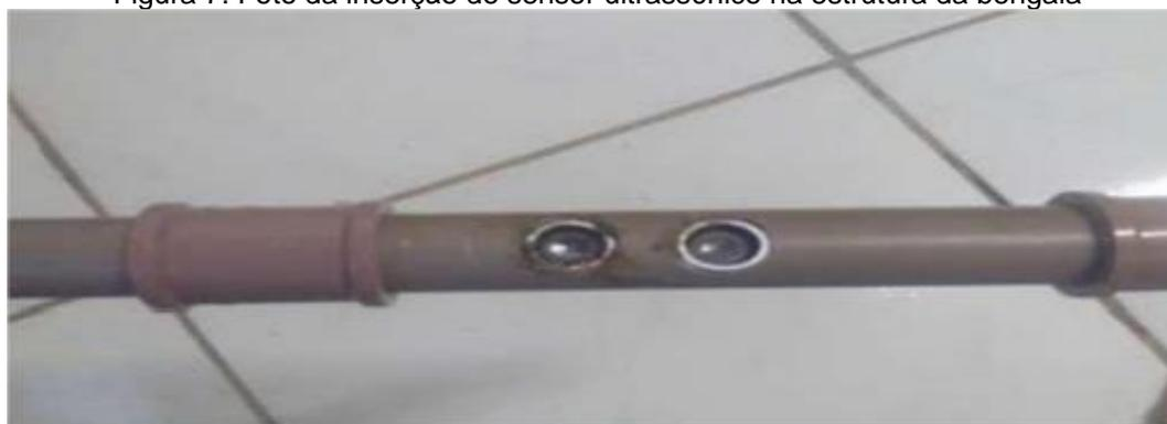
O sensor ultrassônico HC-SR04 é aplicado no projeto pelo seu baixo custo e por ter a capacidade de identificação de obstáculos a distancias que variam de 2,0 cm até 4,0 m, com margem de erro de 3,0 mm. O sensor HC-SR04 é composto de um emissor e um receptor ultrassônico, onde o sensor emite sinais ultrassônicos que serão refeletidos no no obstáculo e/ou objeto, retornando ao sensor receptor (Figura 8).
